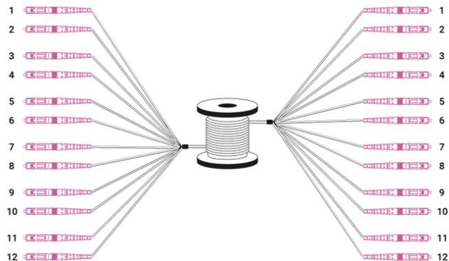
**Câble breakout 12 fibres, OM4, LC/UPC – LC/UPC universel, couleur noir, 30 m**
