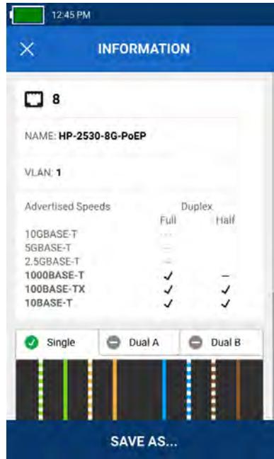
Switch Port-Prüfung zeigt Port Nummer, Switch-Name und Port-VLAN zusammen mit angegebener Geschwindigkeit und Duplex-Einstellungen an. Wenn Sie nach unten scrollen, werden die Ergebnisse für Power over Ethernet angezeigt.
