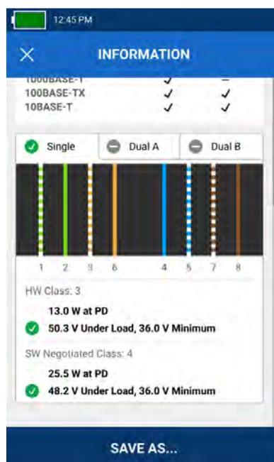
Die Power-over-Ethernet-Einstellungen des Switchports zeigen die verwendeten Paare, die verfügbare Leistung und Klasse sowie die Ergebnisse des PoE-Tests unter Last.
