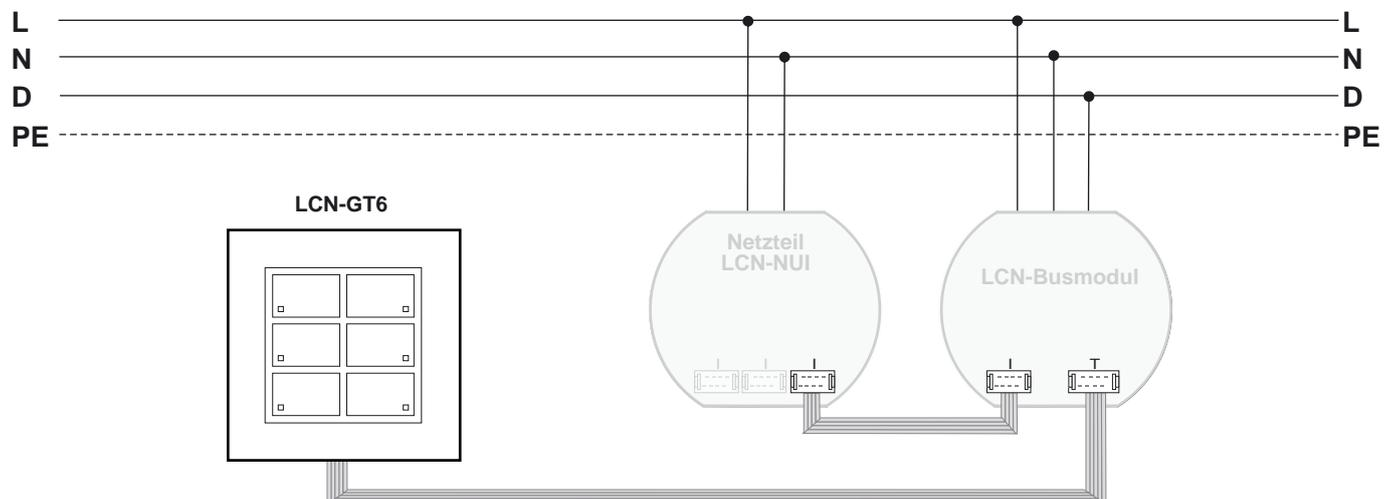
Netzteil LCN-NUI (optional) für Tasten-Hinterleuchtung und Corona®-Lichtkranz
