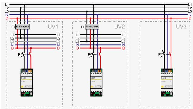
Für die saubere Trennung von Verteilungen können bis zu einer Reichweite von ca. 50 Metern für alle Teilstrecken zusammen die Trennverstärker LCN-IS eingesetzt werden.
