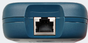
RJ45 Test-Port (Koax über optionalen Adapter)
