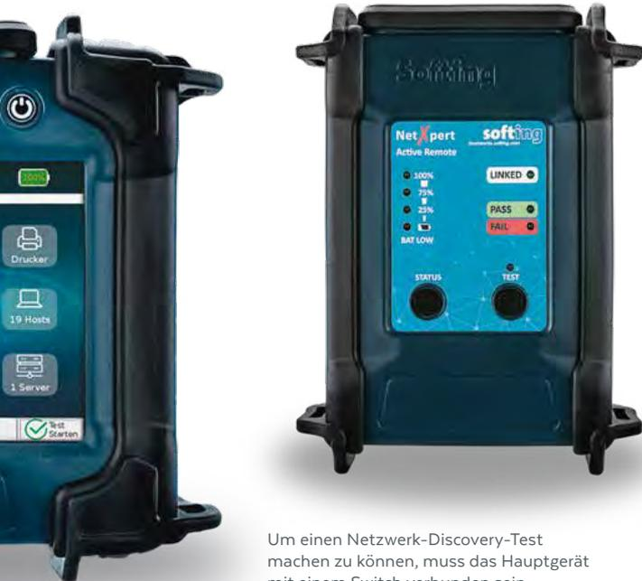
Um einen Netzwerk-Discovery-Test machen zu können, muss das Hauptgerät mit einem Switch verbunden sein.
