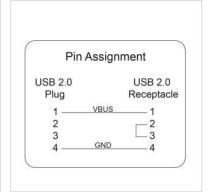
Le protecteur de données USB de type A annule les voies de données du port USB utilisé et protège ainsi votre appareil contre les accès indésirables ou les logiciels malveillants - il ne transmet rien d'autre que de l'énergie. Cette solution est particulièrement utile dans les lieux publics où les prises USB peuvent être manipulées ou détournées relativement facilement, tels que par exemple les hôtels ou les aéroports ou gares.
