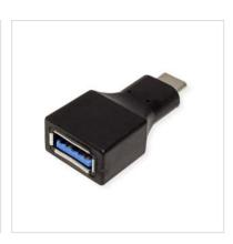
Adaptateur USB 3.0 / USB 3.2 Gen 1 avec fiche de type C et prise de type A, avec un taux de transfert de données jusqu'à 5 Gbit/s. Prise en charge de l'USB On-thego (OTG), par exemple pour transférer des données d'un smartphone/tablette vers un SSD ou une clé USB.
