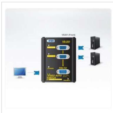
Le commutateur vidéo auto VS201 est un commutateur vidéo automatique idéal pour les moniteurs utilisant des signaux analogiques. De plus, le VS201 amplifie les signaux, permettant ainsi la transmission longue distance jusqu'à 65 m.
