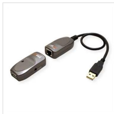
UCE260 peut facilement envoyer les signaux USB via câble Cat.5/5e/6 jusqu'à 60 mètres (196 pi) avec un taux de transfert haute vitesse (480Mb/s), pleine vitesse (12Mb/s) et basse vitesse (1,5Mb/s). Sans aucune configuration ni pilote logiciel, ce système d'extension USB vous permet d'étendre votre périphérique ou hub USB jusqu'à 60m de votre ordinateur, ce qui surmonte la limite typique des câbles USB.
