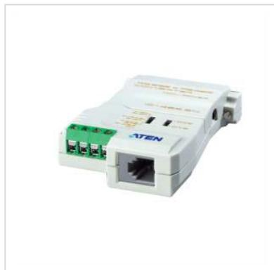
**IC485SN est un convertisseur bidirectionnel pour convertir des signaux RS-232 vers et depuis des signaux RS-422/RS-485 dans des applications longue distance jusqu'à 1200 m - sans avoir besoin d'une alimentation externe.**
