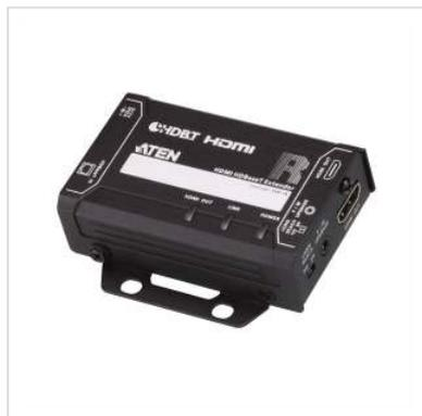
Le récepteur HDBaseT HDMI ATEN VE811R garantit la connexion HDMI optimale jusqu'à 100 m sur un seul câble Cat 5e/6/6a ou ATEN 2L-2910 Cat 6. Le VE811R est conforme aux spécifications HDMI, notamment les formats audio 3D, Deep Color, HD sans perte et la transmission CEC. Il prend en charge les signaux audio et vidéo Dolby Digital 5.1, DTS HD à des résolutions allant jusqu'à 4K.
