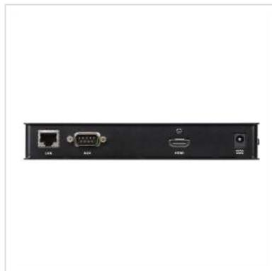
**Le système d'extension KVM HDMI sur IP mince KE8900S est un ensemble émetteur (KE8900ST) / récepteur (KE8900SR) sur IP hautes performances compact et abordable qui permet d'accéder à un ordinateur depuis une console USB distante sur un intranet.**
