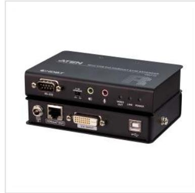
**Der ATEN CE611 ist ein USB DVI HDBaseT™ KVM Extender, der die neuesten HDBaseT™ Technologien integriert, um 1920 x 1200 DVI Video, Stereo-Audio, USB und RS-232 Signale bis zu 100 Meter über ein einziges Cat6 / 6a Kabel / ATEN 2L-2910 Cat 6 Kabel zu übertragen.**
