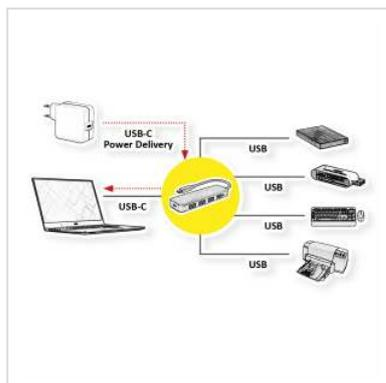
**Mit diesem Hub können bis zu vier USB 3.0 / USB 3.2 Gen 1 Peripheriegeräte an den USB Typ C Port eines PCs angeschlossen werden**
