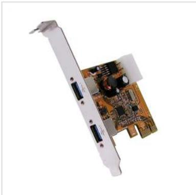
Die EX-11092-2 USB 3.0 PCI-Express Karte stellt zwei verschraubbare Super-Speed USB 3.0 Ports zur Verfügung. Sie ist entwickelt worden, um zwei weitere USB 1.1, 2.0 oder 3.0 Endgeräte an Ihre Workstation, Desktop oder Server anzuschließen. Sie unterstützt USB 1.1 Low-Speed (1.5Mbps), Full-Speed (12Mbps), USB 2.0 High-Speed (480Mbps) und USB 3.0 Super-Speed (5Gbps). Sie ist die perfekte Technologie für externe Speicher Gehäuse, Digitale Kameras, Webcams, Scanner und mehr.
