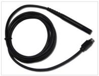
Der Sensor wird einfach in die Schnittstelle des Expert Power Control NET gesteckt. Daraufhin sind die aktuelle Temperatur und Luftfeuchtigket am Sensor über das Webinterface und über SNMP abrufbar. Technische DatenLänge: ~ 2mAnschluss: PS2Temperaturbereich: -30°C bis +80°C bei  $\pm 0,5$ °C , Feuchte 0-
