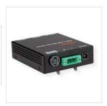
L'injecteur Gigabit PoE++ est un PSE, c'est-à-dire un appareil fournissant en courant les équipements tels que les caméras IP, les points d'accès, ponts et routeurs via câble Ethernet. Un PSE envoie le courant en plus des données à travers le câble réseau. Il n'y a donc pas besoin de mettre en place un adaptateur secteur supplémentaire.
