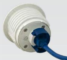
Setzen Sie das Sensormodul wieder ein, wie in *Abschnitt «Installation von PTMount und Sensormodul»* beschrieben. Drehen Sie ggf. den Einsatz auf die ursprüngliche Position zurück und kontrollieren Sie das Livebild der Kamera wie in *Abschnitt «Inbetriebnahme S15D mit PTMount»* beschrieben. Schrauben Sie alle zuvor gelösten Schrauben wieder fest.
