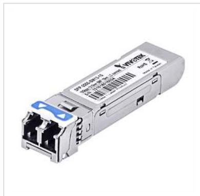
**Module émetteur-récepteur 10 Gigabit SFP+, 9/125µm, 10km, connecteur LC-Duplex**
