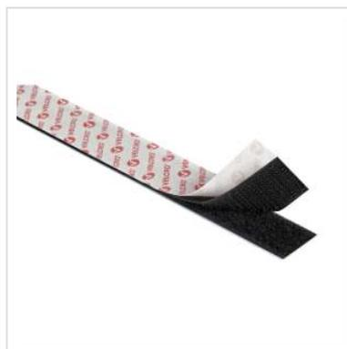
**Velcro de la marque VELCRO®. Profil moyen. Ruban velcro auto-adhésif pour un grand nombre de surfaces telles que l'aluminium, l'acier inoxydable, le verre, le contreplaqué et le polyester. Le ruban auto-adhésif Velcro ne convient pas au polyéthylène, au polypropylène ni au vinyle-PVC. Résistance moyenne à la température. Puissance d'adhésion moyenne.**
